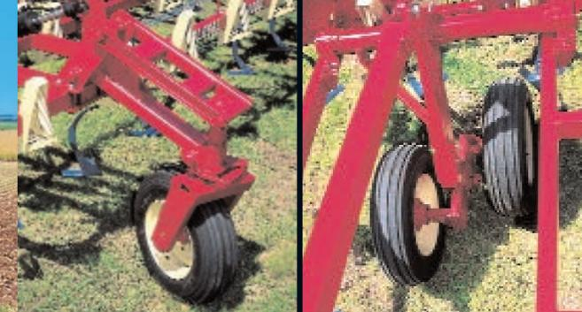
Ruedas delanteras: Giratorias (360°), montadas sobre brazos articulados y accionadas mediante cilindros hidráulicos de elevación compensada.
