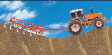
Independiente del resto de la estructura: un eficaz complemento para el control de profundidad en terrenos accidentados, con lomas y hondonadas.
