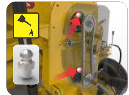
Ubicación: masa eje sinfin y barra de mando Intervalo: cada 8 horas de funcionamiento.
