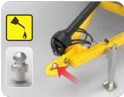
Ubicación: punta lanza de transporte Intervalo: cada 20 horas de funcionamiento.
