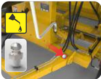
Ubicación: buje lanza de transporte Intervalo: cada 20 horas de funcionamiento.
