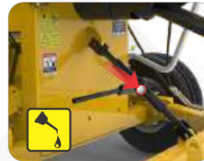
Ubicación: crique de ajuste de altura Intervalo: Intervalo: cada 50 horas de operación
