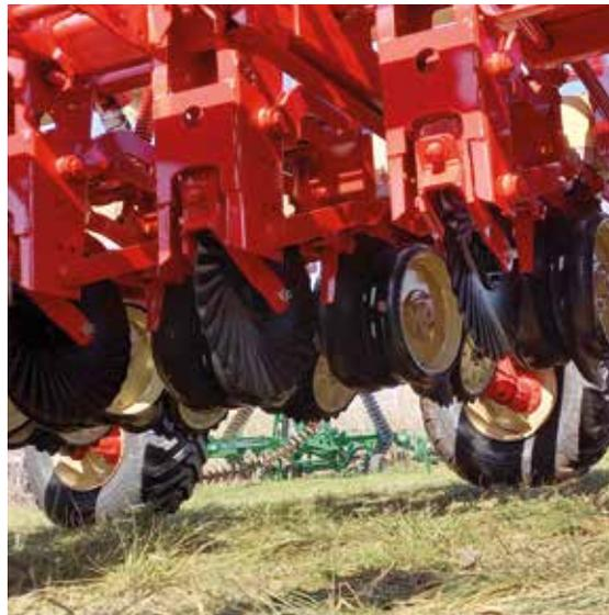
Cuchillas de corte en detalle
